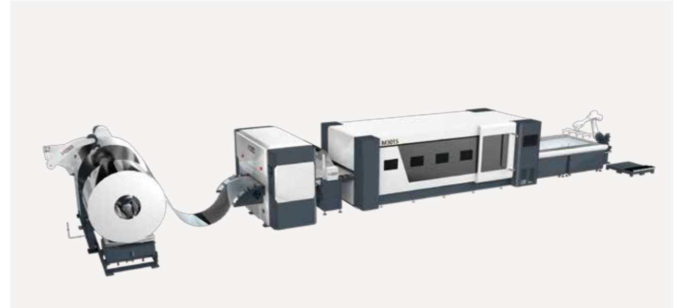
(1)开卷+全自动高精度矫平(送料)+覆膜+激光切割+自动落料(可选关节机器人/关节机械手)
